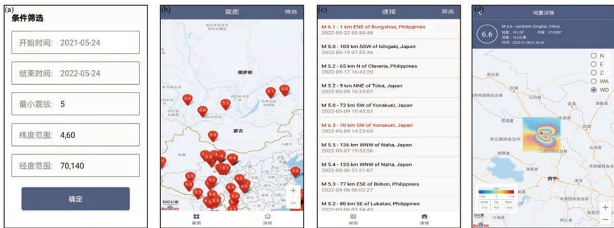
图 4 震形图 APP 四大模块. (a) 条件筛选模块; (b) 地震分布信息模块. 默认显示中国及周边地区当前时间一年内 5 级以上地震分布情况; (c) 地震速报信息模块. 默认加载我国及周边地区当前时间一年内 5 级以上地震信息, 对于 6 级以上地震标红显示; (d) 地震形变信息模块. 底图右上角形变图类型选择按钮, 红点代表震中位置, 且点击按钮加载沙滩球, 左下角为形变图图例和震源机制解参数
