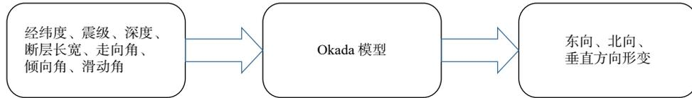
图 2 Okada 模型计算地震地表形变
